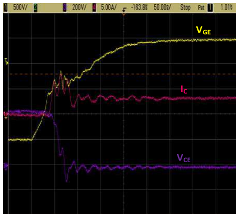
Fig. 8. Representación del encendido en la configuración individual
