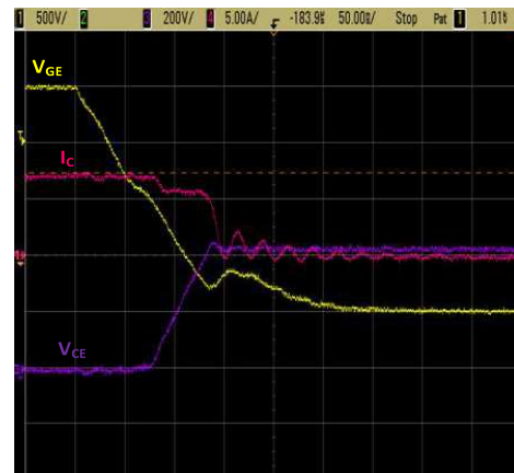
Fig. 6. Representación del apagado en la configuración individual
