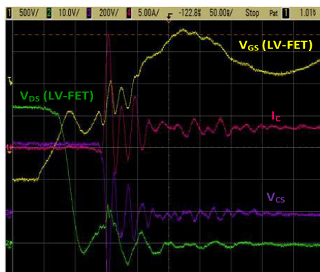
Fig. 9. Representación del encendido en el cascodo
