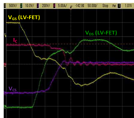
Fig. 7. Representación del apagado en el cascodo
