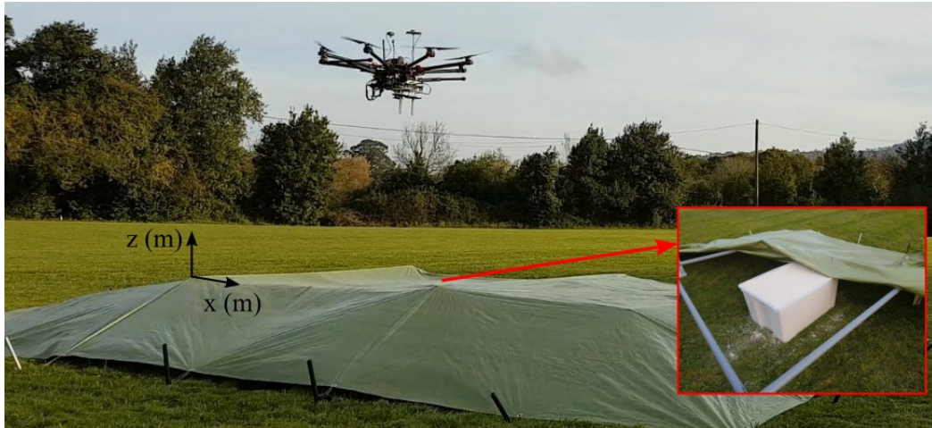
Figura 4. Setup para las pruebas de vuelo de GEODRON.
