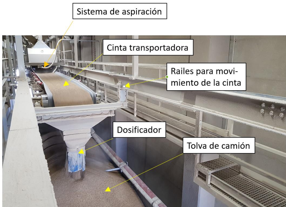
Figura 6: Sistema mecánico de dosificado de tolva de camión
