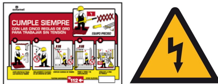
Figura 32 - Ejemplo de señales de riesgo eléctrico tipo AE-21.
