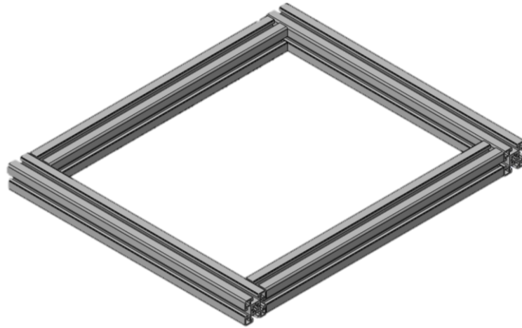
Figura 5.9. Cuadro del bastidor del prototipo.
