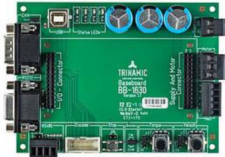
Figura 5.19. Placa de evaluación BB-163X, compatible con el módulo TMC-1630.
