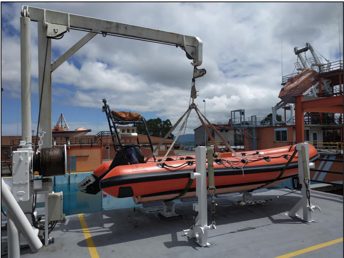
Imagen 25 Bote de rescate estibado en cubierta
