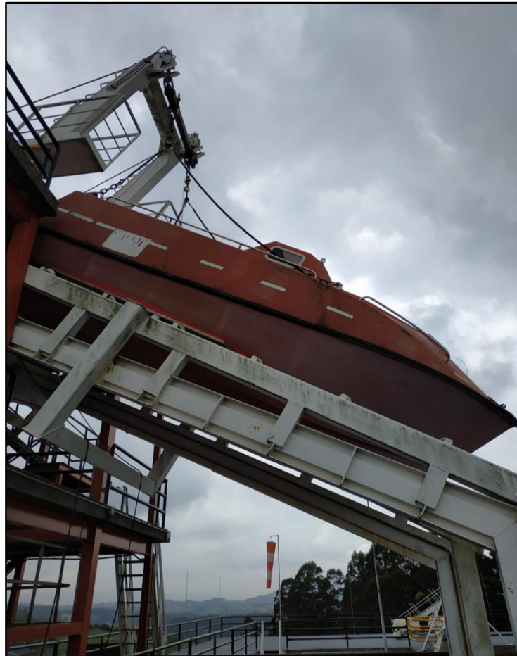
Imagen 20 Bote salvavidas de caída libre instalado sobre plataforma
