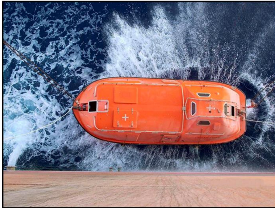
Imagen 7 Suelta de los ganchos (con carga) de un bote salvavidas
