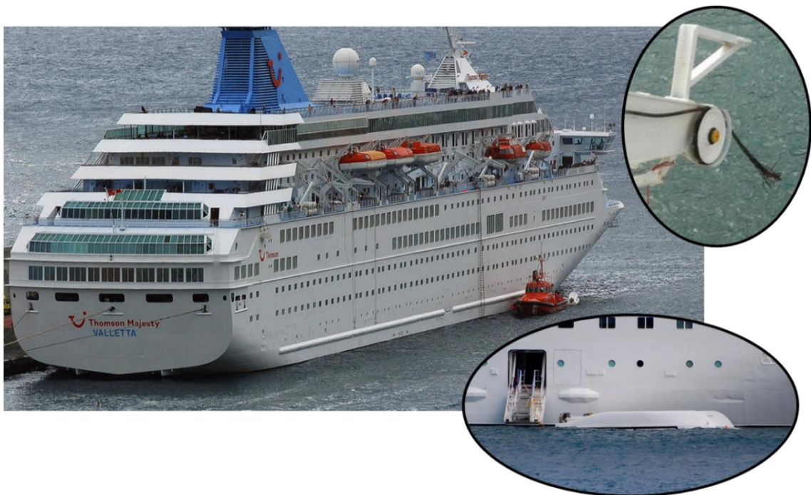
Imagen 36 Crucero Thomson Majesty / Sup.Dcha.: Fallo alambre / Inf. Dcha. Embarcación quilla al sol
