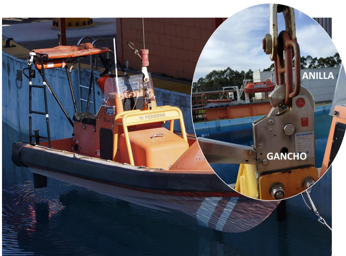
Imagen 29 Gancho de suelta automática-anilla bote de rescate rápido
