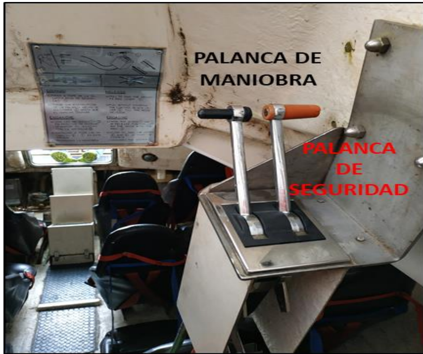
Imagen 23 Sistema de accionamiento del gancho del bote salvavidas de caída libre
