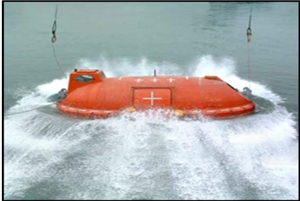
Imagen 6 Suelta de los ganchos (sin carga) de un bote salvavidas
