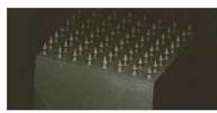
Figura 2.10.- Silva, M Tiago et al. (2015) Conjunto de HYPER pines hecho por fabricación aditiva
