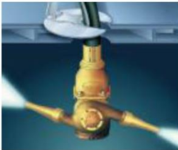
Ilustración VII: Máquinas portátiles de lavado colocadas en tanques. Fuente: https://ingenieromarino.com/limpieza-de-tanques-petroleros/#.XSsm_kugzblU
