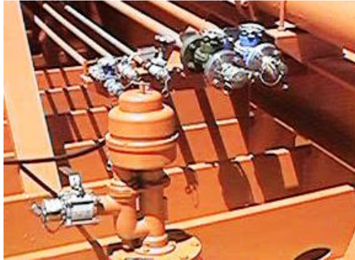
Ilustración VI: Máquina fija de lavado vista desde cubierta. Fuente: Autor.
