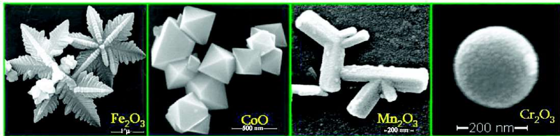
Figura 1.11. Imágenes SEM de nanoestructuras de varios óxidos metálicos obtenidos por síntesis hidrotérmal con microondas [80].
