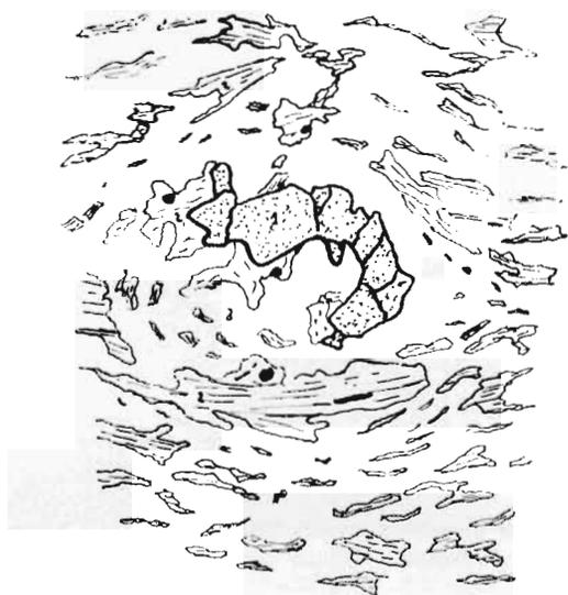
Fig. 1.—Nódulo de las micacitas granatíferas con un granate anhedral. 1 granate. 2. biotita. 3. cuarzo. (Dibujo sobre una fotografía microscópica. Aumento aproximado 40 d.).
