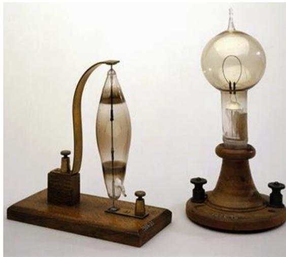
Figura 2.7.- Lámpara incandescente con filamento de carbono.
