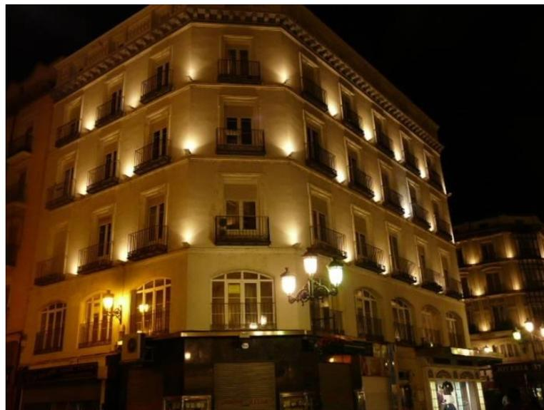
Figura 2.9.-Fachada con unos niveles de iluminación excesivos provocan un alto consumo energético.
