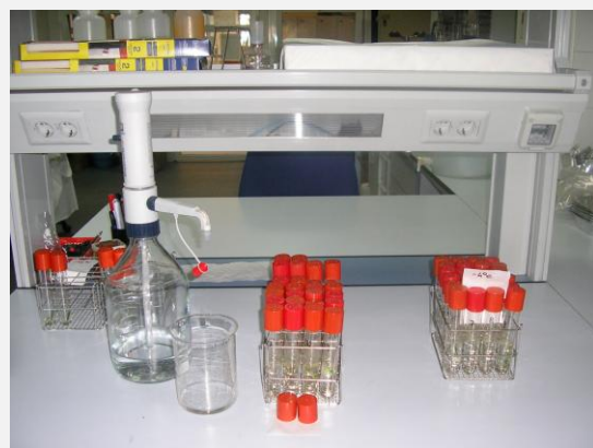
Figuras II.3 y II.4. Preparación de las muestras para el método de liberación de electrolitos.
