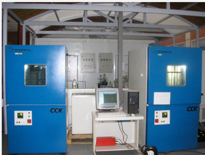
Figura II. 5 y II.6. Cámaras climáticas en las que se llevó a cabo el ciclo del frío y la rotura celular total.
