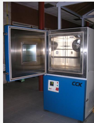
Figura II. 5 y II.6. Cámaras climáticas en las que se llevó a cabo el ciclo del frío y la rotura celular total.
