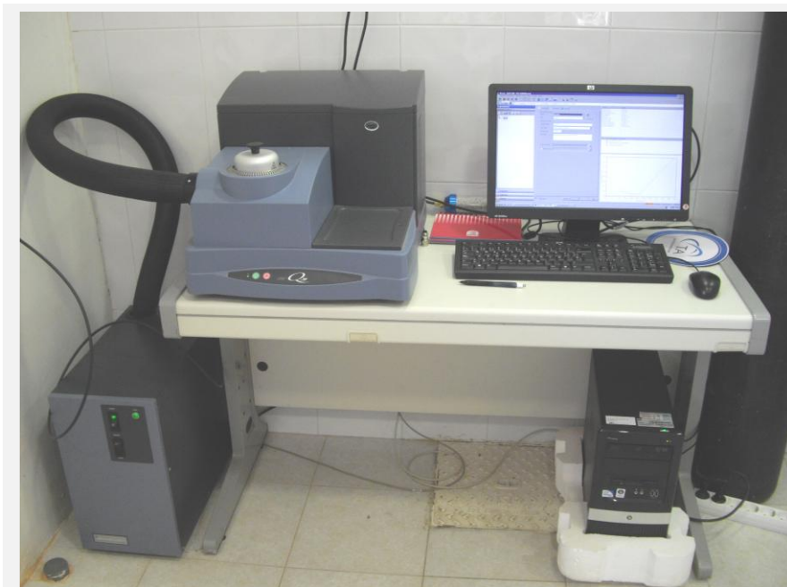
Figura II.9. Calorímetro de barrido diferencial (CBD) con control de flujo másico (CFM) y sistema de enfriamiento por refrigerador (SER).
