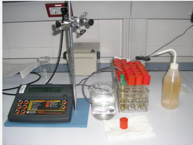
Figuras II.7 y II.8. Medición de la conductividad eléctrica de las muestras.
