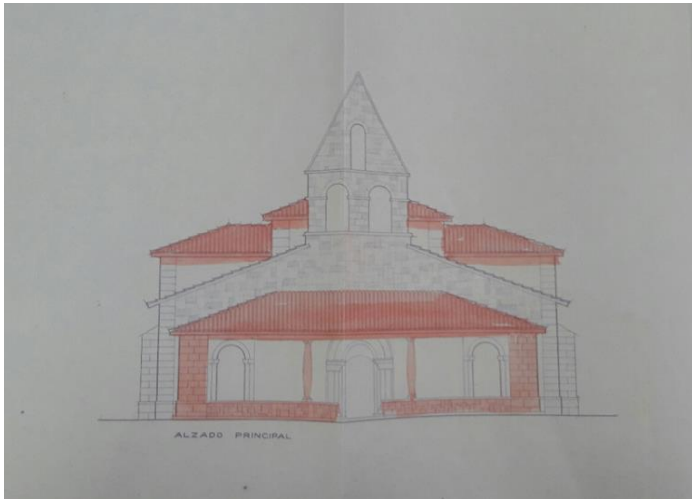
Fig. 111. Fachada principal de San Nicolás con las zonas dañadas destacadas.
