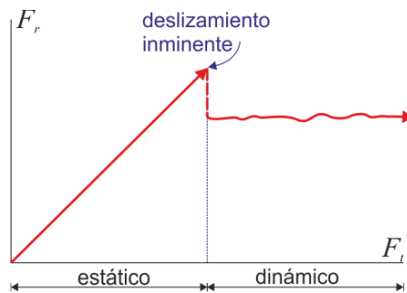
Figura 12: Comportamiento dinámico de fricción de Coulomb
