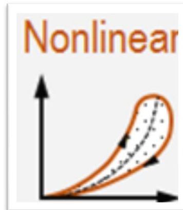
Figura 30: Ley no lineal disipativa para modelo de fuerzas de contacto
