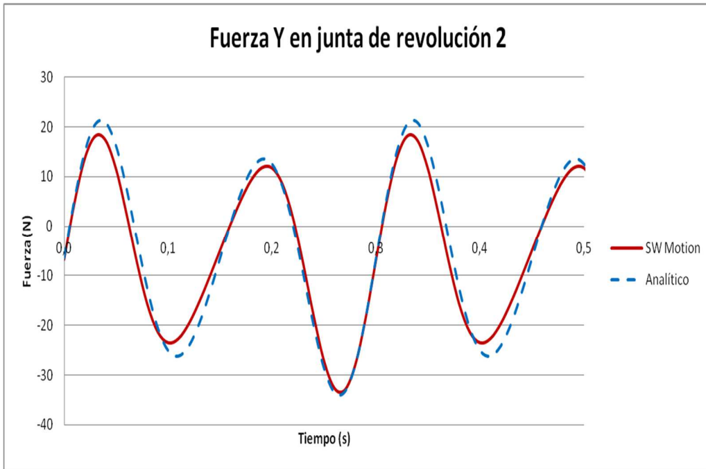
Figura 83 – Comparativa modelo analítico vs simulación. Fuerza Y en junta revolución 2 (análisis dinámico).
