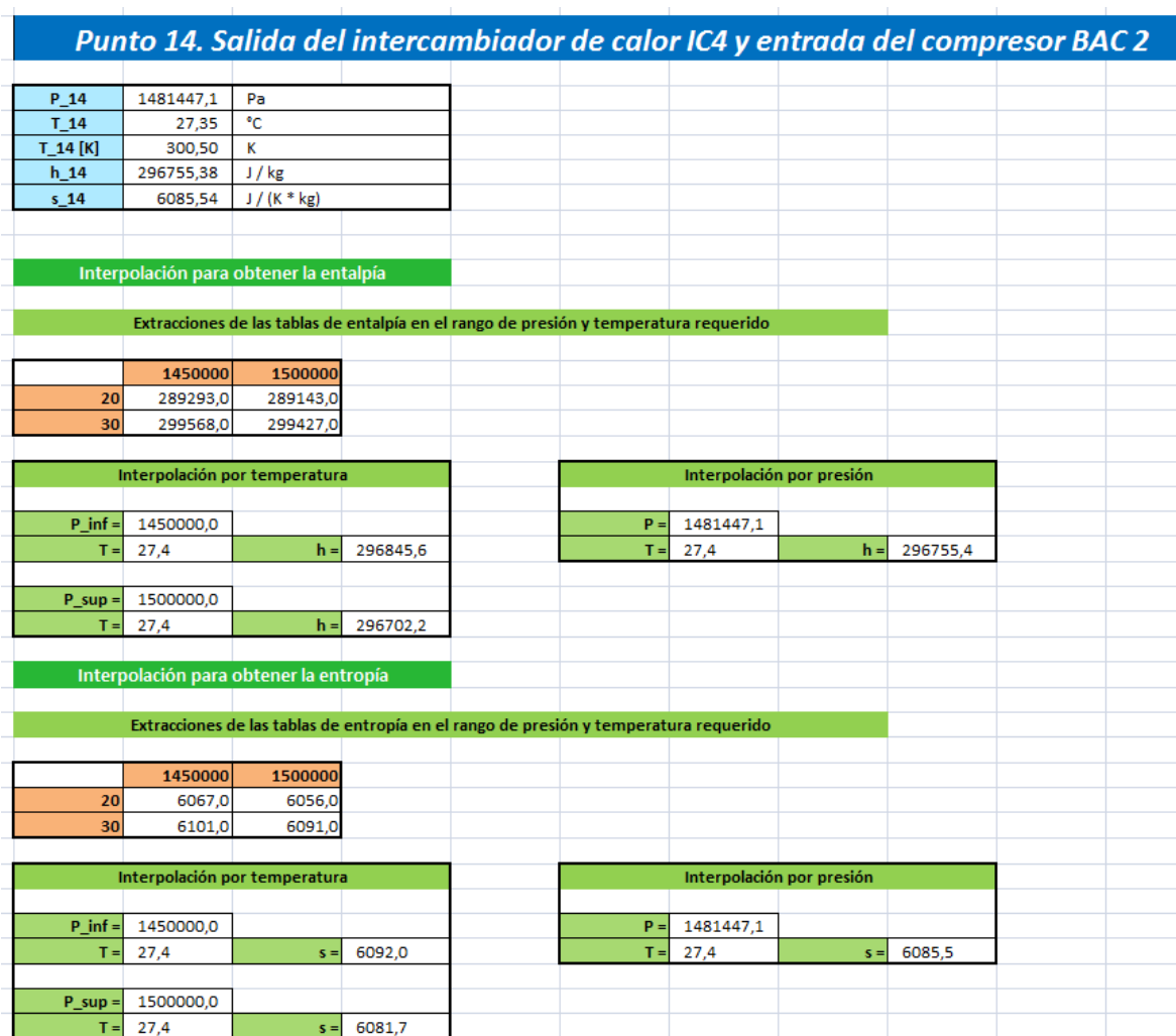
Figura 9.11. - Vista de uno de los puntos del proceso del lado de aire seco en el programa diseñado
