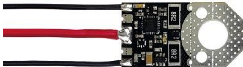
Ilustración 4-20 Imagen del módulo de monitorización de celda G1 (Fuente: Emus).
