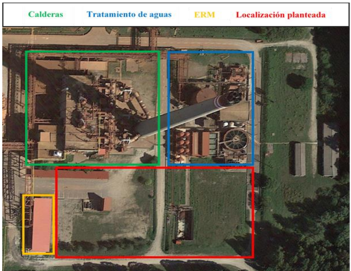
Figura 62: Esquema de la implantación
