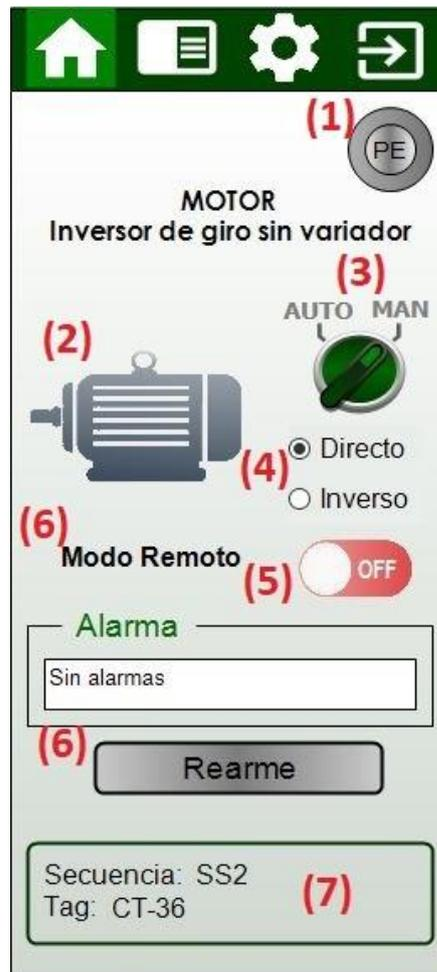
*Figura 29.- Pantalla inicio del faceplate del motor sin variador y doble sentido de giro*
