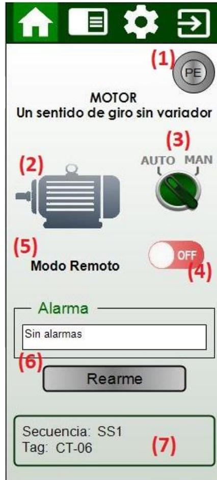
Figura 26.- Pantalla inicio del faceplate del motor sin variador y un sentido de giro
