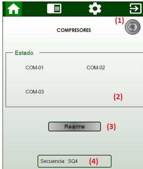
*Figura 44.- Pantalla inicio del faceplate de los compresores*
