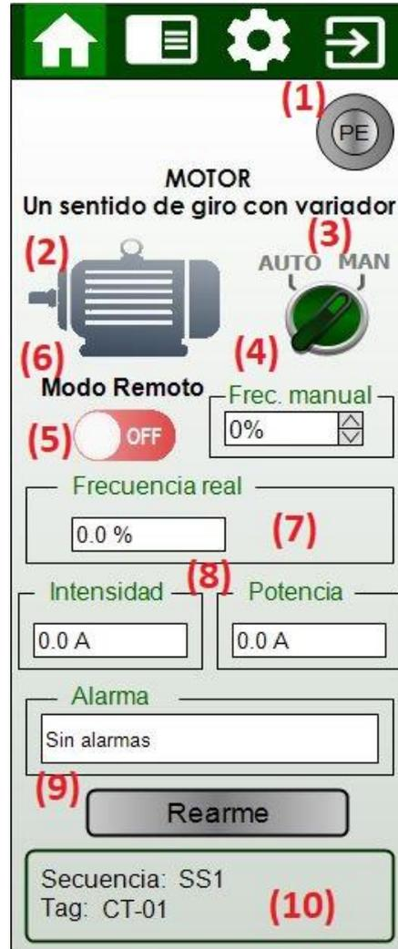
*Figura 32.- Pantalla inicio del faceplate del motor con variador y un sentido de giro*
