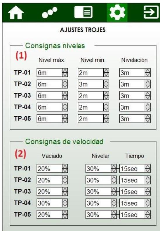
*Figura 42.- Pantalla ajustes del faceplate de los trojes*
