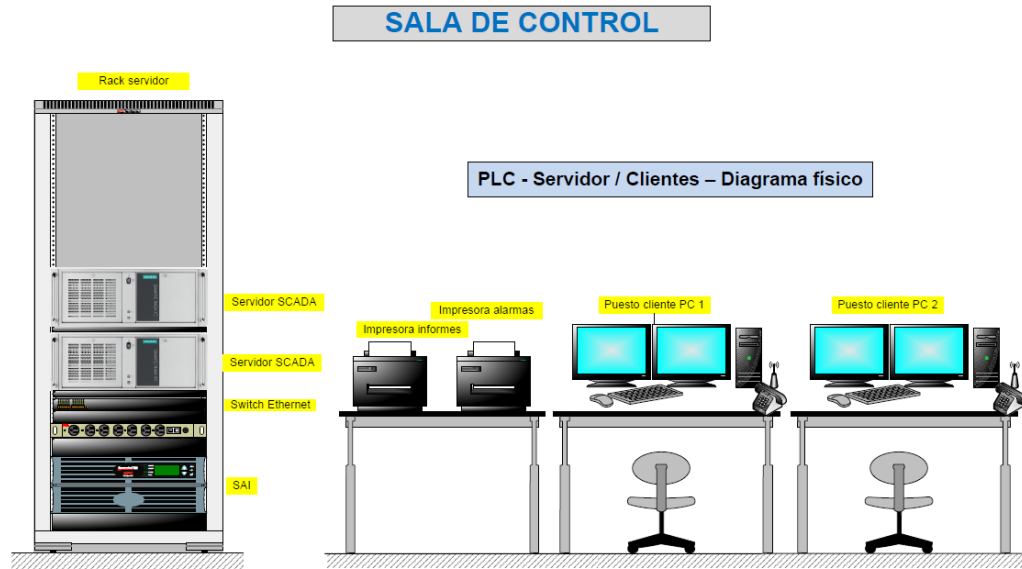
Figura 19: Diagrama físico sistema de supervisión
