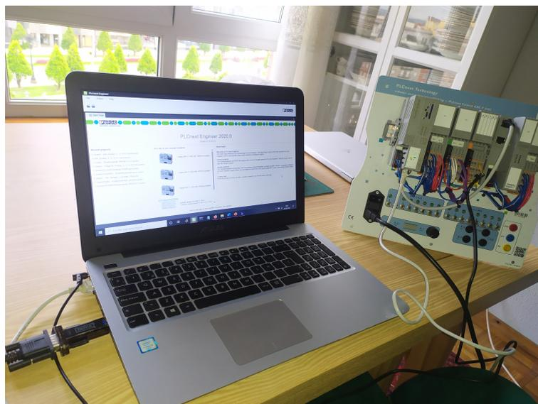
Fig. 2.11. Conexión comunicación serie PLC-AIS.
