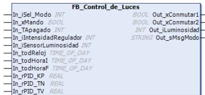
Figura 3-3 - Representación del bloque funcional de control de luces
