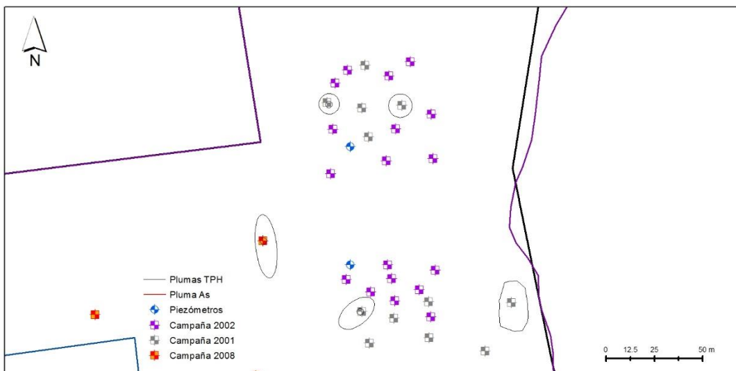
Figura V.20. Localización plumas de TPH y puntos de muestreo campañas anteriores.
