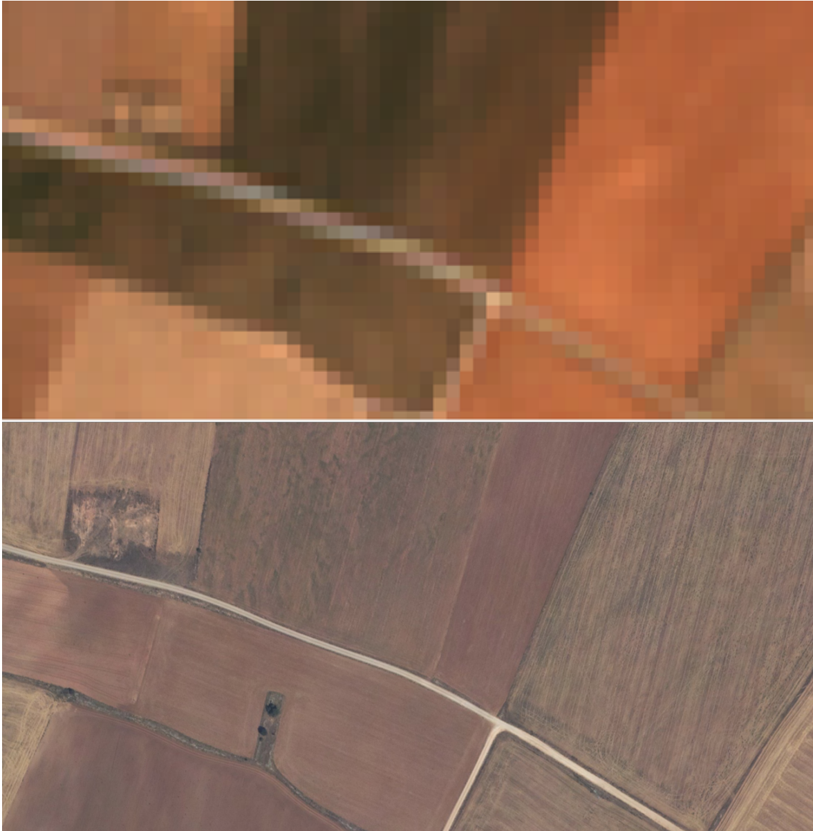
Figura 6.1.- Comparativa entre imágenes RGB de PNOA (inferior) y de Sentinel-2 (superior) sobre la misma región.
