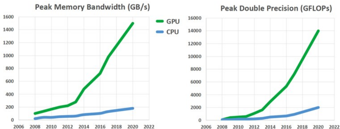
Figura 1.1.- Comparación de GFLOPs/s y GB/s proporcionados por GPUs y CPUs. [1]
