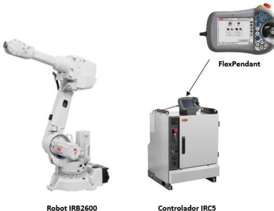
Figura 2.5.- Imagen del robot IRB2600 y el controlador IRC5. Cortesía de [6].
