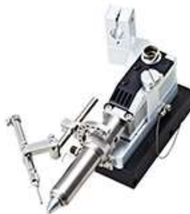
Figura 2.8.- Cabeza del soldador UMC-093ª. Cortesía de[7].
