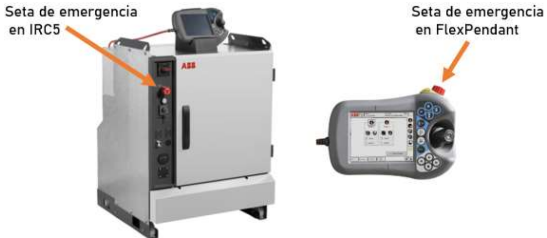
Figura 4.11.- Setas de emergencia del sistema robótico.
