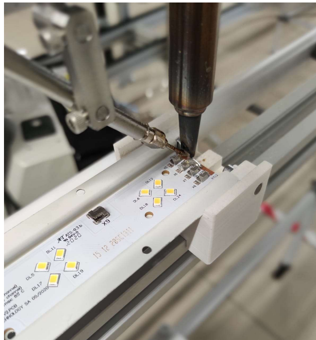
Figura 3.9.- Fotografía del soldador de Japan Unix realizando una soldadura a las tiras de LED.
