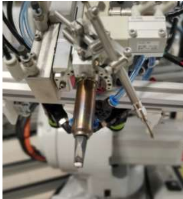
Figura 4.5.- Fotografía del soldadora con el tubo de estaño separado.
