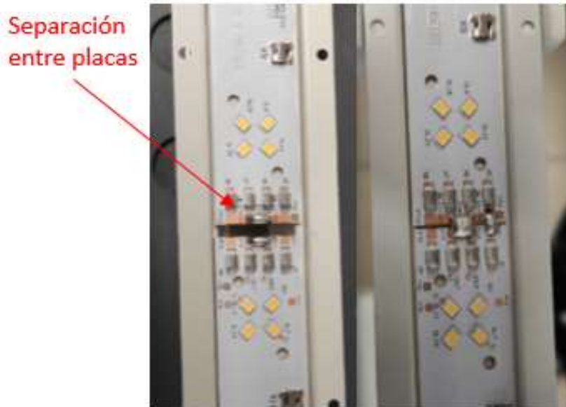
Figura 4.4.- Fotografía de una soldadura con las placas separadas frente a una con ellas juntas.
