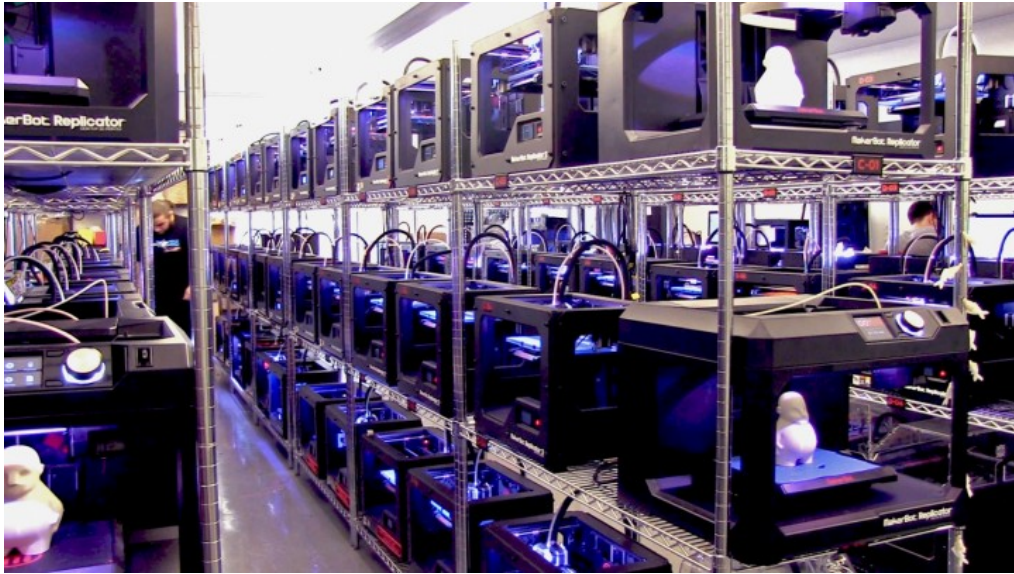
Figura 1. 17.- Granja de fabricación aditiva. Producción en serie
