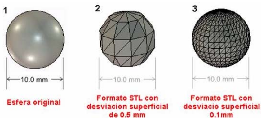
Figura 2. 11. Ejemplos distintas densidades de malla en archivo STL
