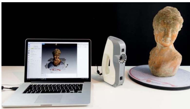
Figura 2. 13.- Ejemplo de obtención archivo .PLY
