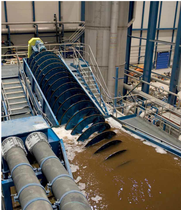
Imagen 7. Clasificador de espiral. Se indica el recorrido de los granos.
