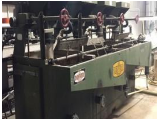
Imagen 11. Celdas de flotación por espumas
