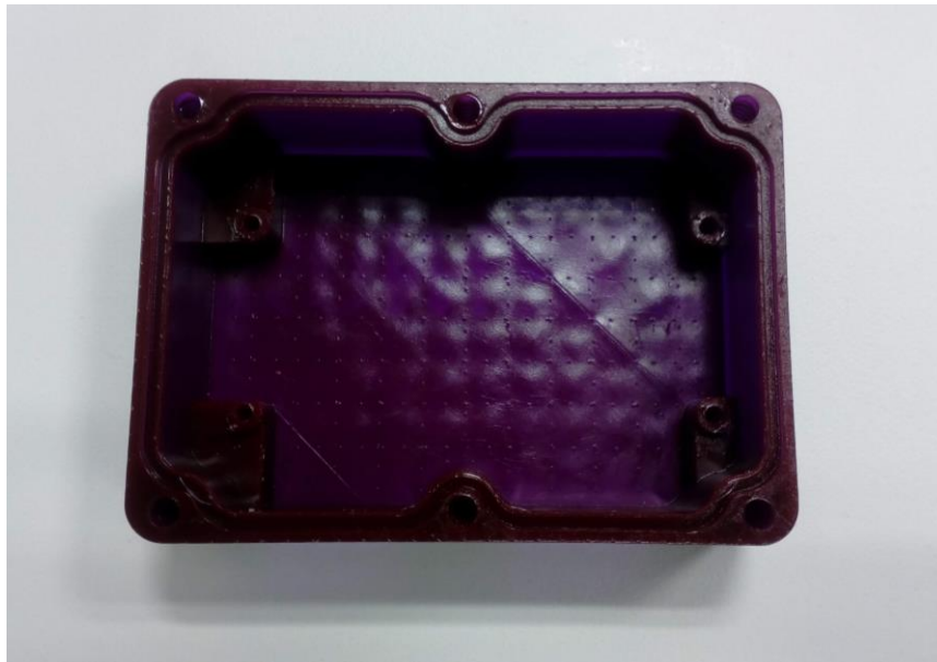
Figura 54 ranura para la junta tórica de 1mm
