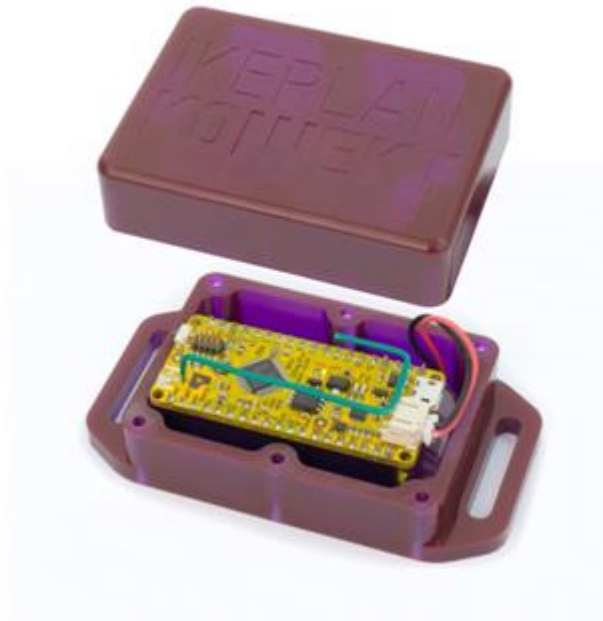
Figura 56 Vista interna del nodo sensor 1
