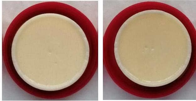
*Figura 31. Sustitutos de grasa con  $\beta$ -carotenos procedentes de la extracción a partir de yema de huevo completa (izquierda) y de plasma (derecha).*
