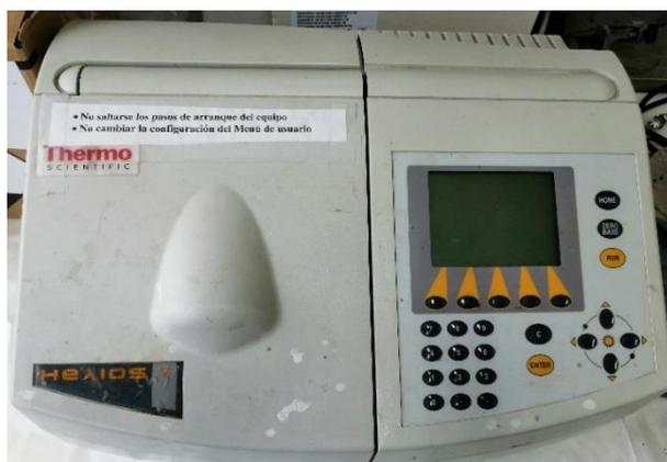
*Figura 11. Espectrofotómetro empleado para cuantificar la cantidad de carotenoides presentes en las muestras.*
