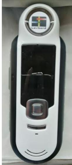
*Figura 13. Colorímetro Lovibond utilizado para medir los diferentes parámetros del color de los sustitutos de grasa.*
