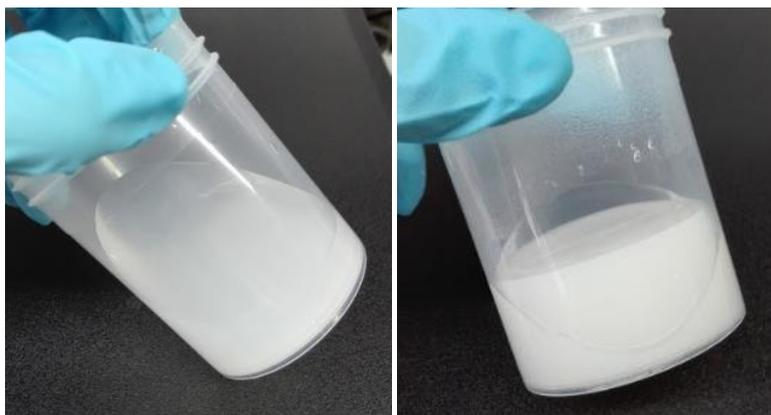
*Figura 14. Comparación de la consistencia de las muestras con un 1% de carragenato (izquierda) y un 3% de carragenato (derecha).*
