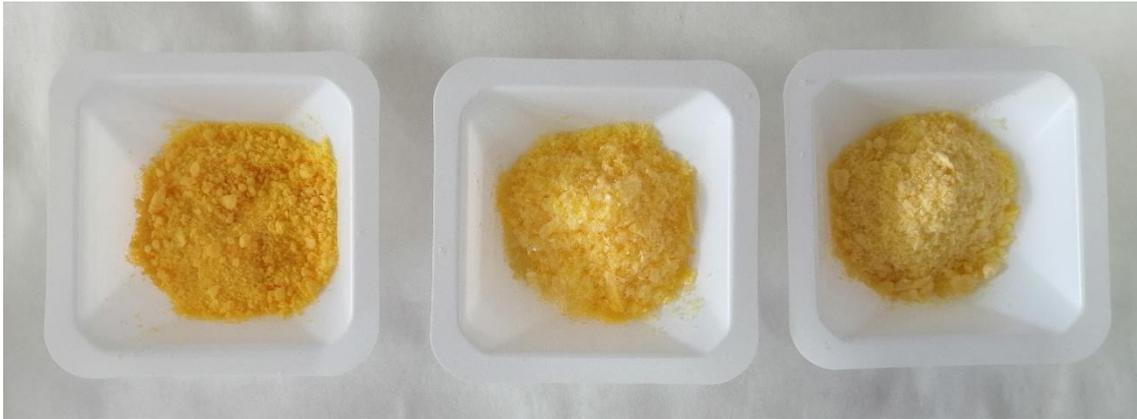
*Figura 6. Muestras resultantes de la liofilización de: yema completa (izquierda), plasma (centro) y gránulos (derecha).*
