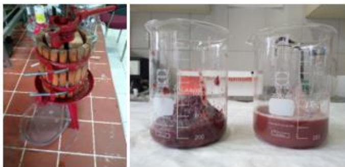
Figura 11. Prensa para la extracción del zumo de la uva (izquierda) y las dos fases obtenidas tras el prensado, siendo estas una fase sólida y una fase líquida que es el zumo de uva (derecha).
