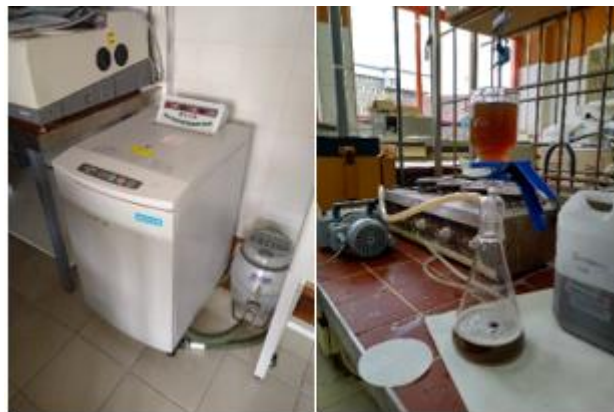
Figura 10. Centrifuga usada para el pretratamiento (izquierda) e instrumental necesario para filtración junto con una bomba de vacío (derecha).
