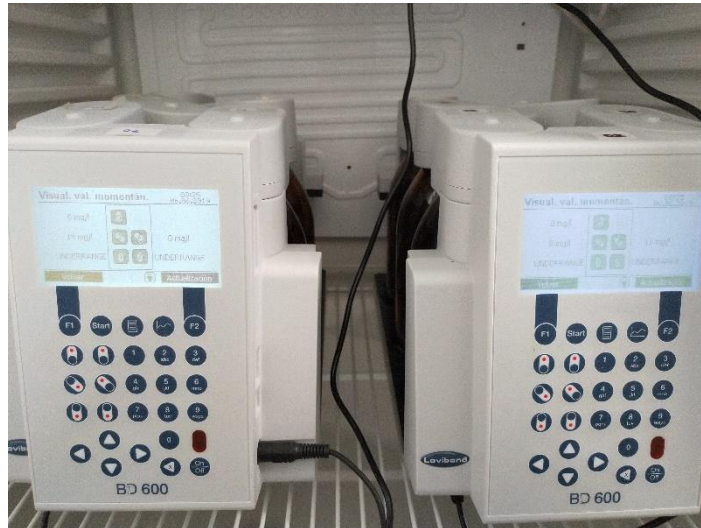
Figura 18. Aparatos de medida para el análisis de la DBO de una muestra, se encuentran en el interior de una nevera la cual mantiene la temperatura dentro de un rango adecuado.
