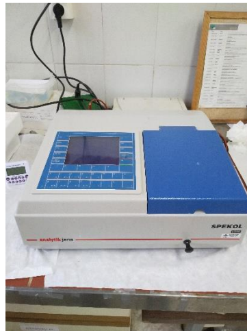
Figura 19. Espectrofotómetro que permite el análisis de múltiples longitudes de onda sobre una muestra en una cubeta de cuarzo usado para la determinación del Índice Colorimétrico.
