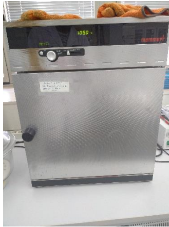
Figura 14. Estufa a la que se le ha fijado una temperatura de 105°C
