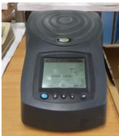
Figura 15. Espectrofotómetro en el que se ha acoplado un sistema que permite la medición de la absorbancia de la muestra directamente desde un tubo de vidrio.
