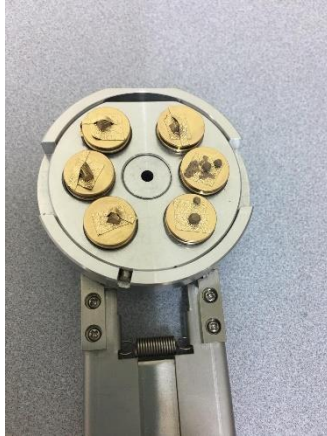
Figura 20. Muestras en el soporte tras sufrir un bombardeo con partículas de oro.
