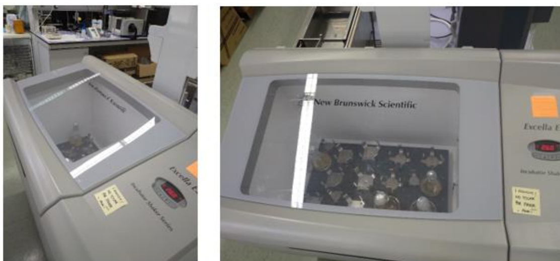
Figura 13. Incubador en el que se realiza el crecimiento de P. chrysosporium y el tratamiento experimental. Permite la regulación de las condiciones del ensayo.
