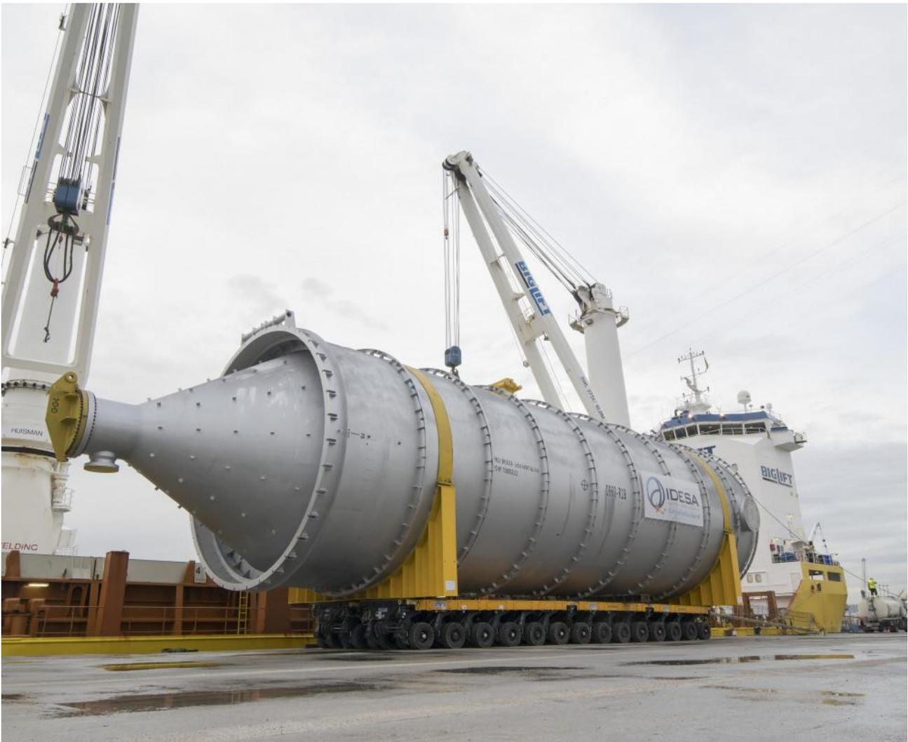
Figura 2: Tambor de coque (Coke Drum) para la empresa Exxonmobil [3].
