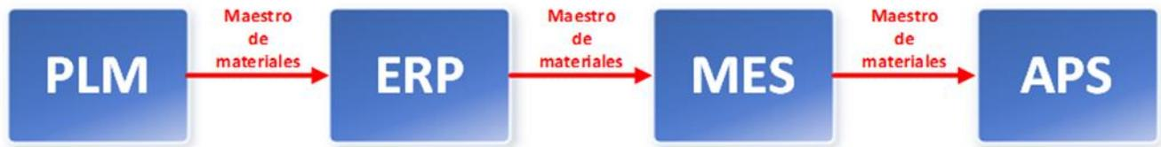
Figura 61: Flujo de datos del maestro de materiales (elaboración propia).
