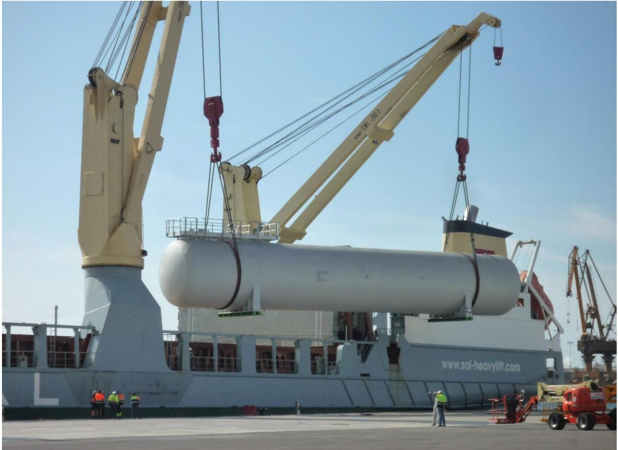
Figura 12: Propane storage drum para la empresa LNG [15].
