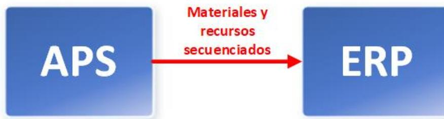
Figura 87: Flujo de datos de la ruta de fabricación y recursos secuenciados (elaboración propia).
