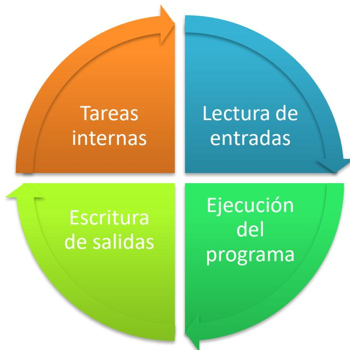
Figura 31: Ciclo de Scan de un PLC (elaboración propia).
