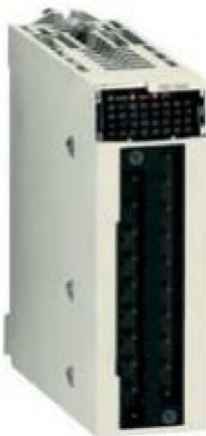
Figura 28: Módulo de entradas BMX AMI 0410 CPU [30].
