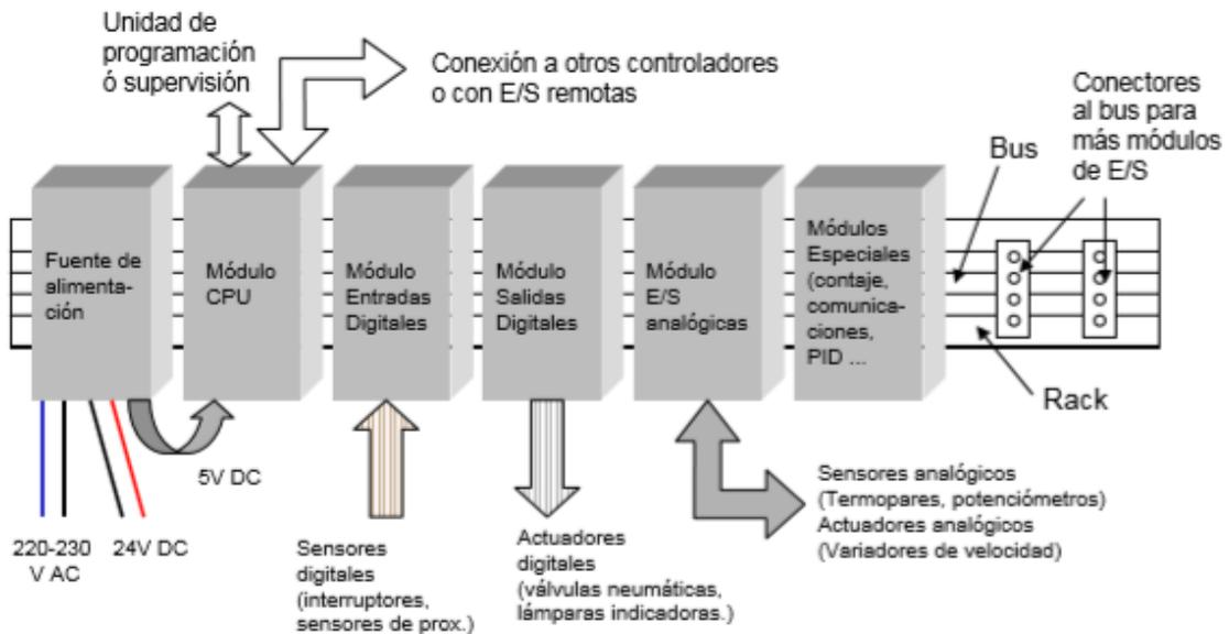
Figura 24: Estructura típica de un autómata programable [29].
