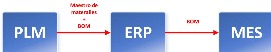
Figura 79: Flujo de datos real del maestro de materiales (elaboración propia).
