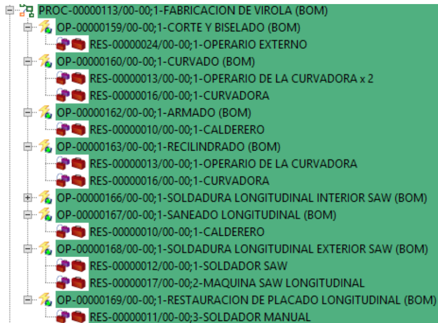
Figura 4.6.- Ejemplo de proceso "Fabricación de virola" en un BOP
