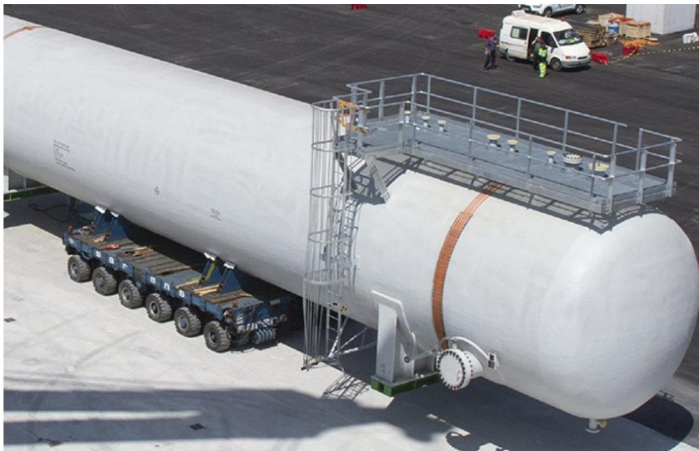
Figura 5.50.- Plataforma y escalera instalada en equipo
