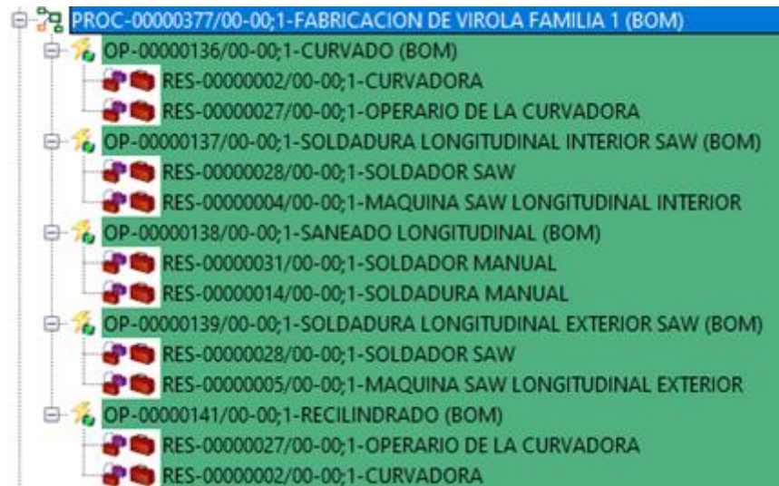
Figura 5.60.- Plantilla de fabricación de una familia de virolas según base de datos
