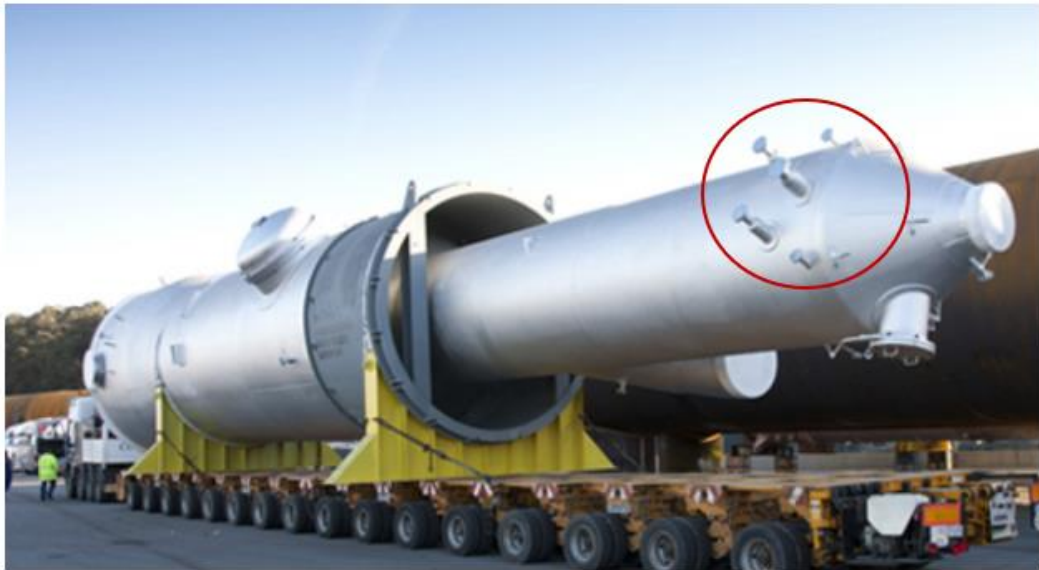
Figura 5.40.- Varias tubuladuras instaladas en un equipo
