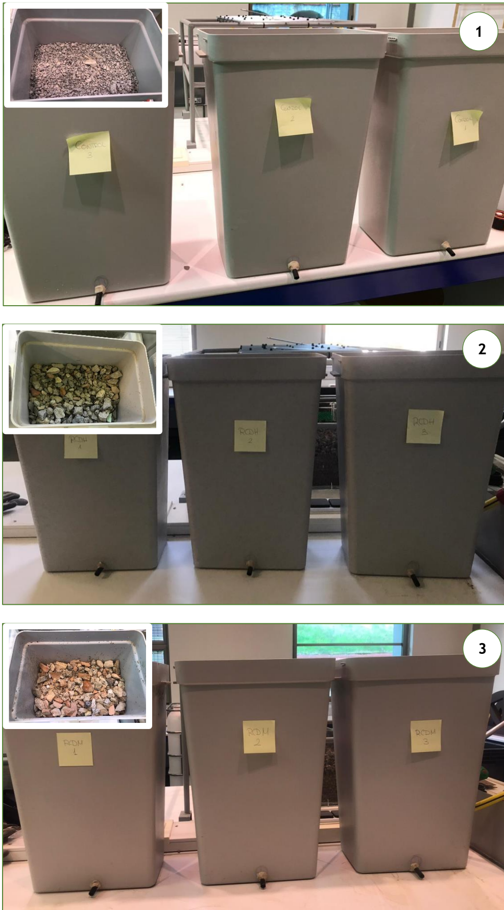
Figura 30. Recipientes de las muestras para los diferentes ensayos: (1) Muestra control, (2) Muestra RCDH y (3) Muestra RCDM.
