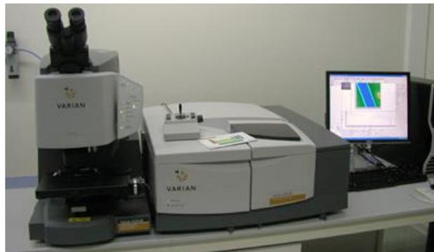
Figura 15: Espectrofotómetro FTIR Varian 620-IR empleado en este trabajo.
