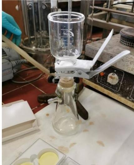
Figura 53. Montaje para la filtración.
