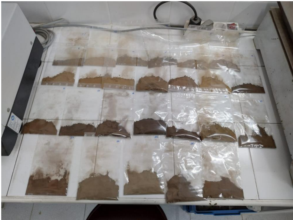
Ilustración 48. Muestras ya molidas y preparadas para su análisis elemental.
