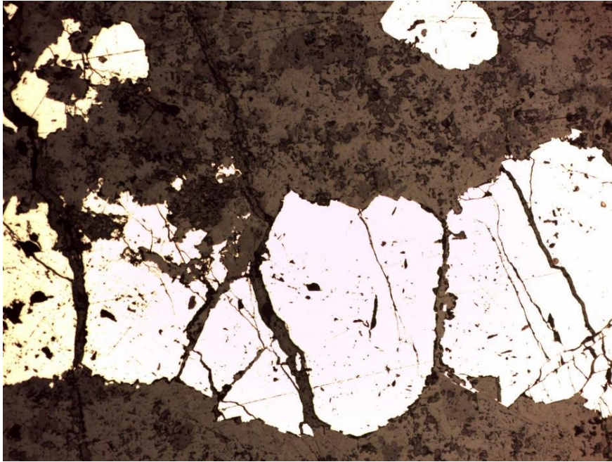
Ilustración 26. Cristales de arsenopirita de tamaño grueso.
