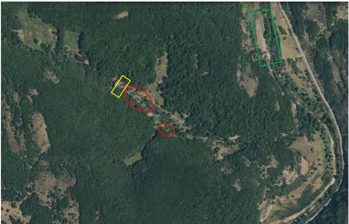
Ilustración 17. Imagen satélite de la Mina Tres Amigos. Las zonas en rojo corresponden a las escombreras, en amarillo la zona de extracción de mineral y en verde las instalaciones metalúrgicas (Fototeca Digital, 2021).
