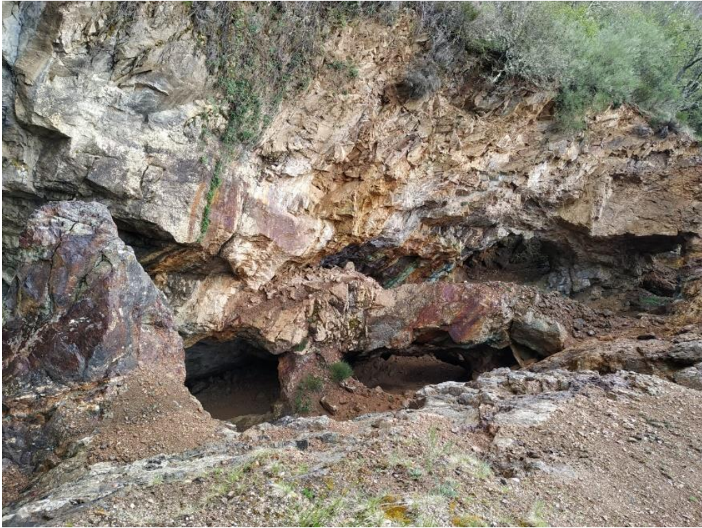
Ilustración 21. Fotografía del interior del socavón de la mina. Nótese los tonos verdes de los carbonatos de Cu y violáceos de los óxidos de Fe.
