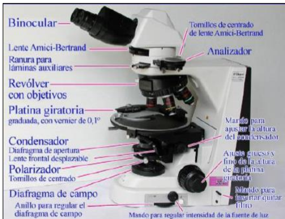
Ilustración 52. Componentes del microscopio petrográfico (Leika Laborluz 12Pol) (Raith & et al., 2012)
