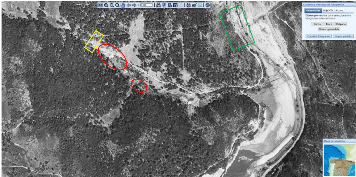
Ilustración 18. Vuelo americano serie B (1956-1957). Las zonas en rojo corresponden a las escombreras, en amarillo la zona de extracción de mineral y en verde las instalaciones metalúrgicas (Fototeca Digital, 2021).
