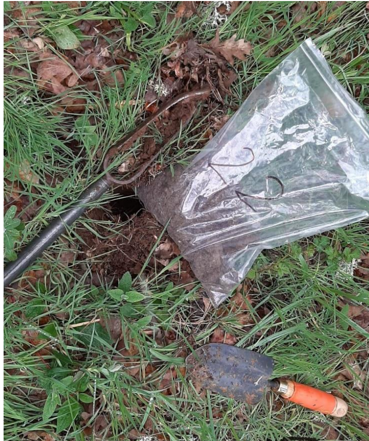
Ilustración 42. Recogida de muestra del suelo.
