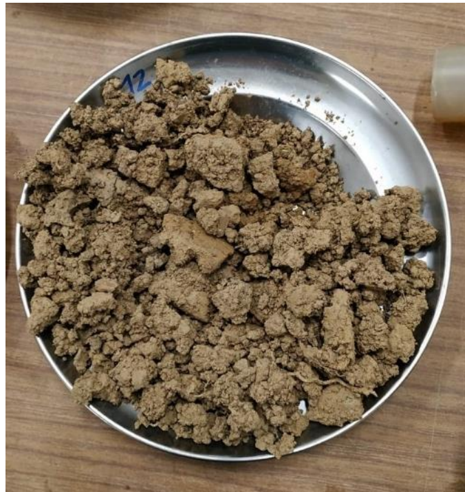
Ilustración 44. Ejemplo de muestra en condiciones aptas para su molienda.
