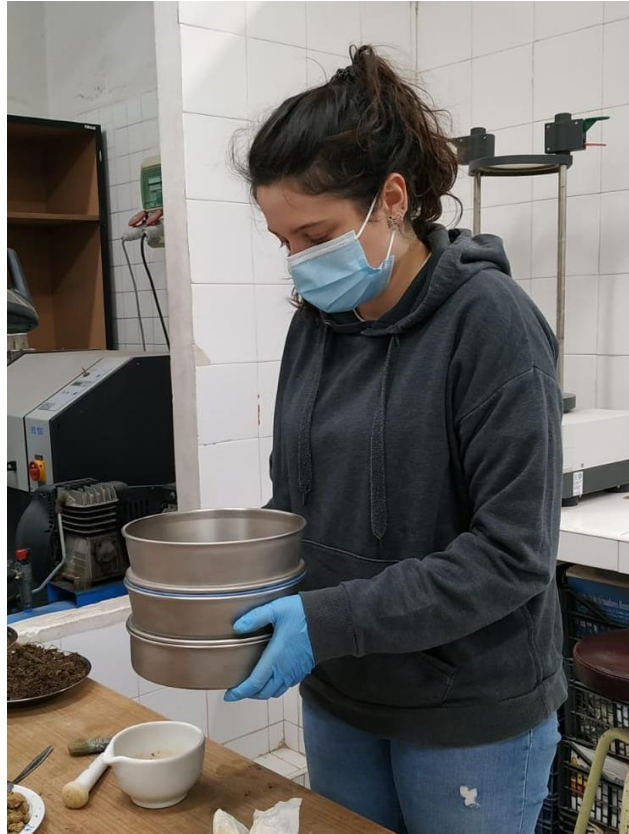
Ilustración 47. Tamizado de la muestra.
