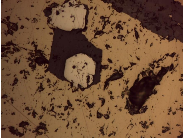
Ilustración 30. Inclusiones minerales en la calcopirita (posiblemente pirita).
