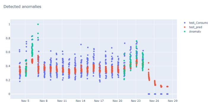
(A) Detección de fugas en sistemas de agua utilizando las medidas de caudal en el transcurso del tiempo.
