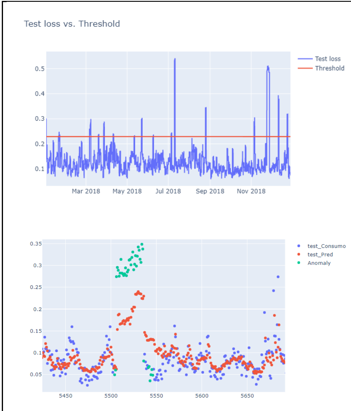
Figura 5-5 En la figura superior el error obtenido tras la predicción y el threshold calculado (línea roja horizontal). En la figura inferior se ha destacado los puntos (puntos verdes) correspondientes a un día completo cuyo error ha superado el threshold.
