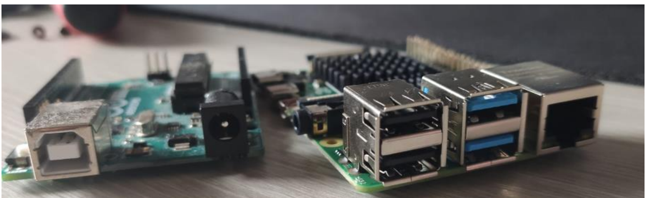
Ilustración 11 Comparativa de entradas salidas entre Arduino UNO y Raspberry Pi 4 B
