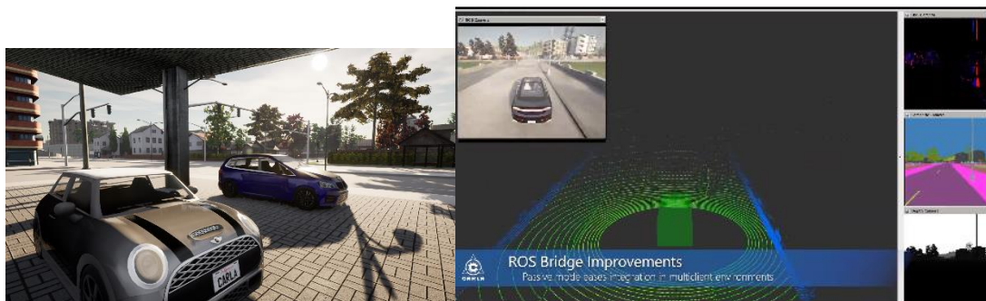
Ilustración 7 Simulador CARLA de base y su extensión de sensor LIDARR
