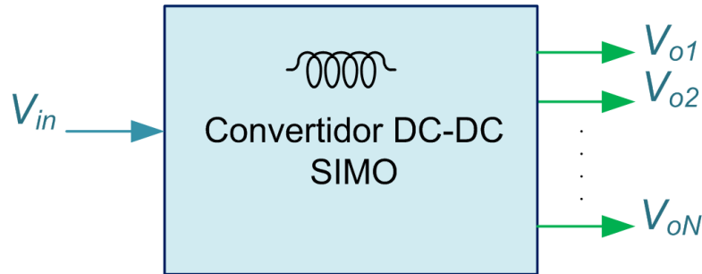
Figura 4.3 Esquema general de la técnica SIMO para convertidores DC-DC.
