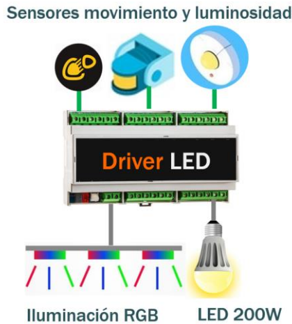
Figura 5.8 Esquema de un Driver de Iluminación LED RGB
