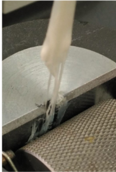
Fig. 3.20. Fallo del tendón sujeto por la zona de sujeción
