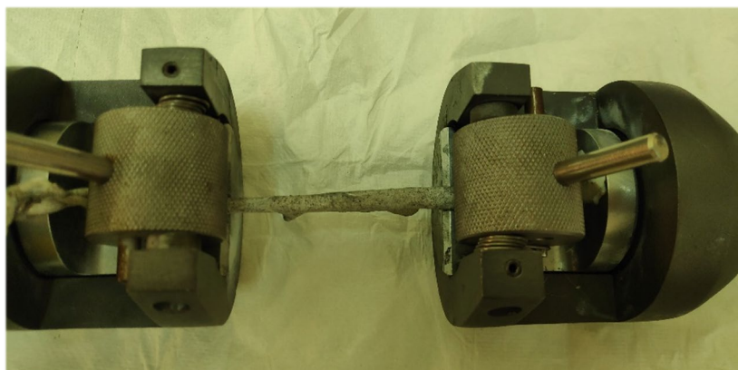
Fig. 3.3. Tendón pintado fijado en mordazas
