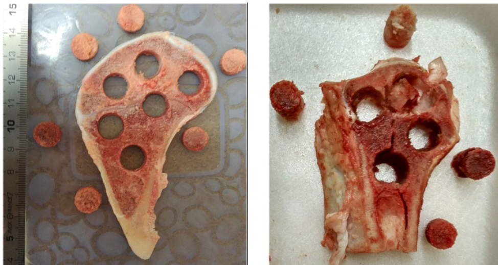
Fig. 3.6. Probetas de hueso trabecular extraídas por troquelado
