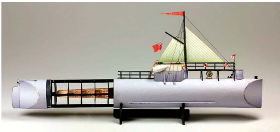
FIGURA 104. Maqueta (1:250) del Cleopatra elaborada por la Walden Model Co. y construida por Oliver Weiss en la que se aprecia la estiba del obelisco en el interior del cuerpo cilíndrico y una gran parte de los elementos marinos acoplados (Copyright 2006-2021 Walden Font Co. d.b.a. Walden Models, and Oliver Weiss).
