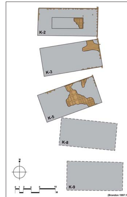
FIGURA 68. Planta y disposición actual de los restos del “área K” del puerto de Sebastos. Nótese la configuración del K-2 con una disposición de “cajas infinitas” (sobre dibujo de BRANDON 1997:17).
