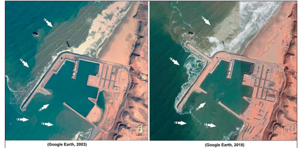
FIGURA 38. Imágenes de satélite del puerto teleférico y el puerto actual, en las que se aprecian las arenas en suspensión que llevan las corrientes marinas, en este caso durante los oleajes del noroeste (con flechas). Google Earth 2003 (izq.) y Google Earth 2018 con el nuevo espigón (dcha.).
