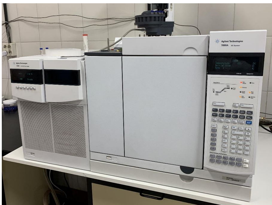
Figura 9. Equipo de cromatografía de gases Agilent GC 7890A acoplado al espectrómetro de masas Agilent 7000 GC/MS Triple Quad.
