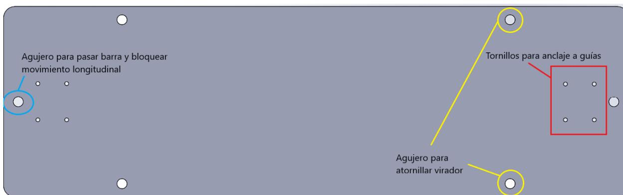
Figura 3. 14. Vista en planta de la base del virador loco
