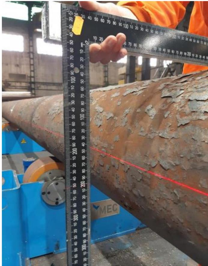
Figura 3. 59. Escuadra con nivel de burbuja para estimar el error del método
