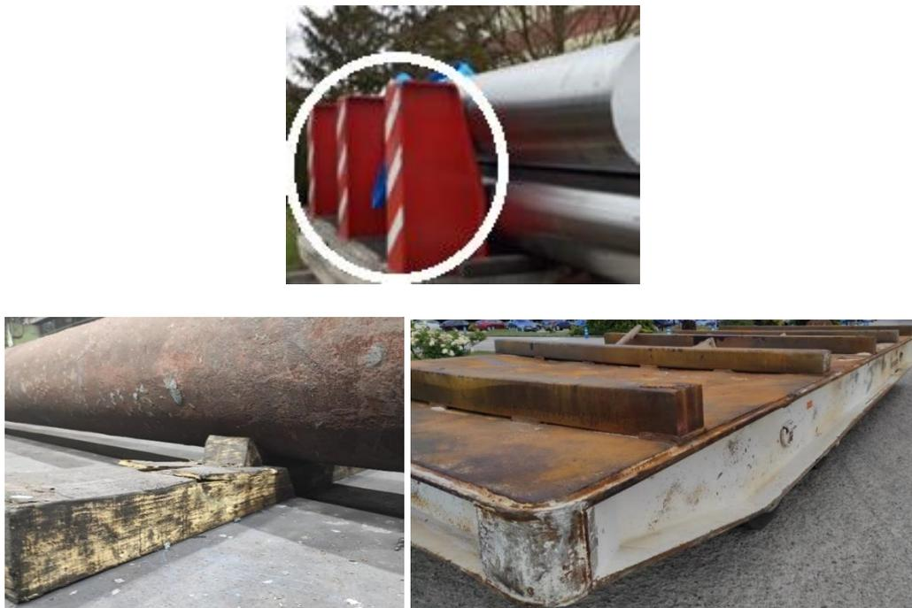
Figura 4. 48. Diferentes métodos de asegurar la carga sobre carros de transporte
