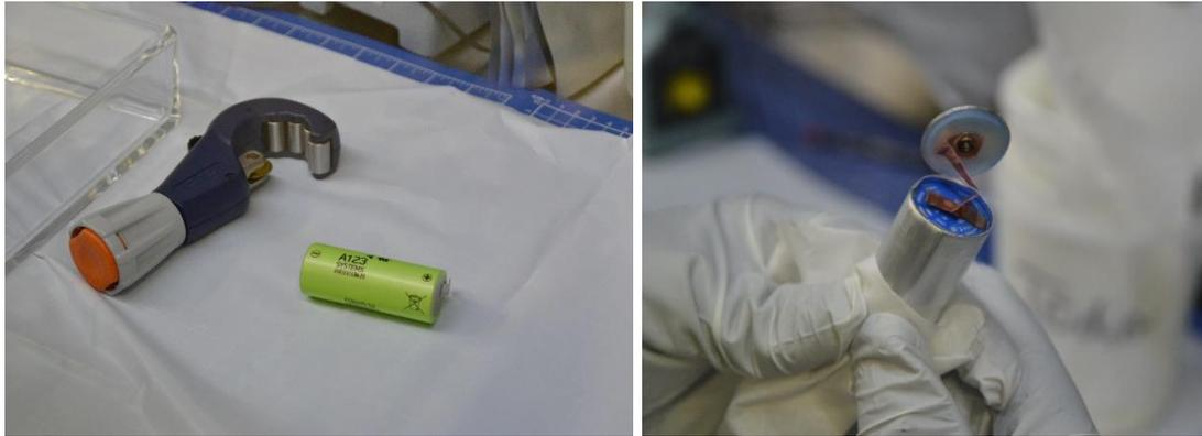
*Figura 5.8. Apertura de celda con cortatuberías para extraer los electrodos.*
