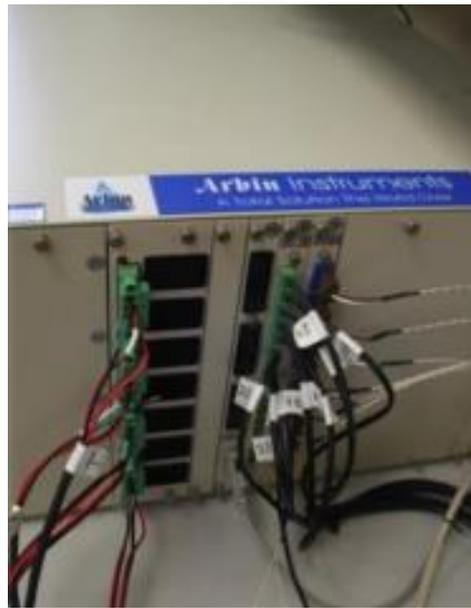
*Figura 5.5. Sistema de prueba Arbin BT-2000.*
