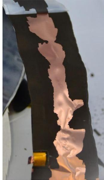
Figura 6.8. a) Electrodo de grafito fresco y b) Electrodo de grafito degradado.
