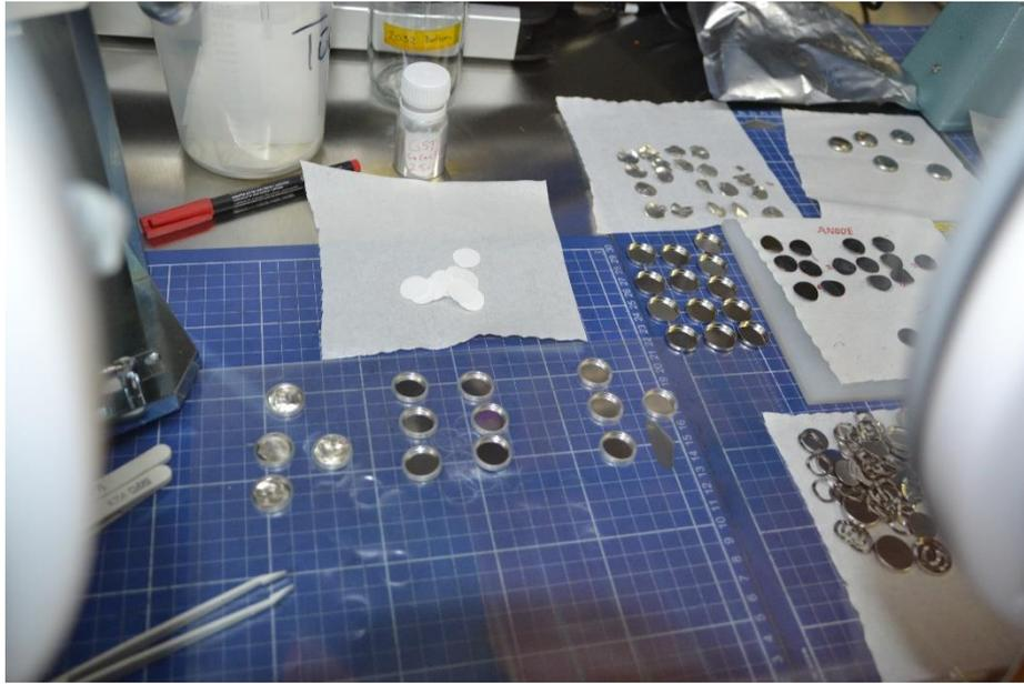
*Figura 5.14. Fabricación en guanteras de celdas botón.*
