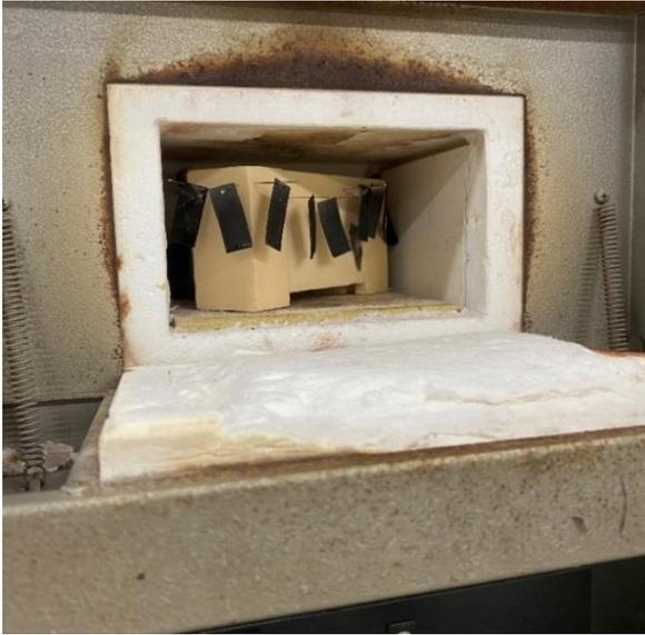
*Figura 6: Electrodo sobre la plataforma de secado, en el interior de la mufla.*
