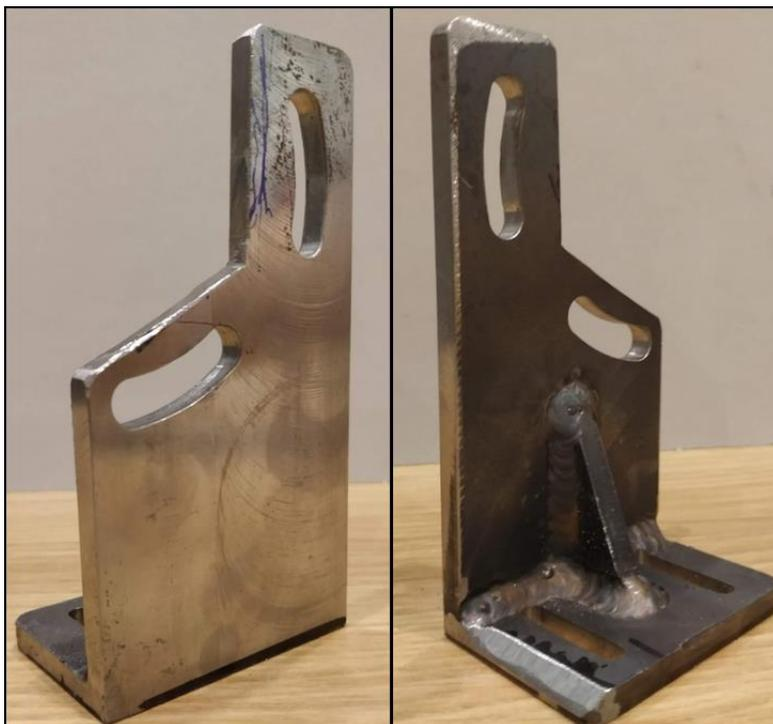
Figura 4.30. Soporte pinza de freno.
