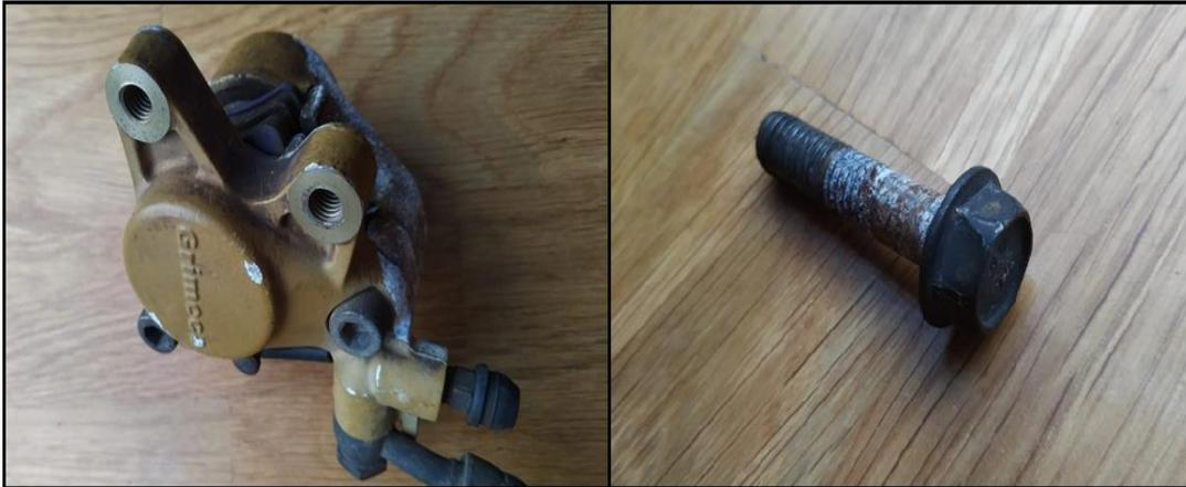
Figura 4.16. Cilindro y agujeros roscados en pinza de freno.
