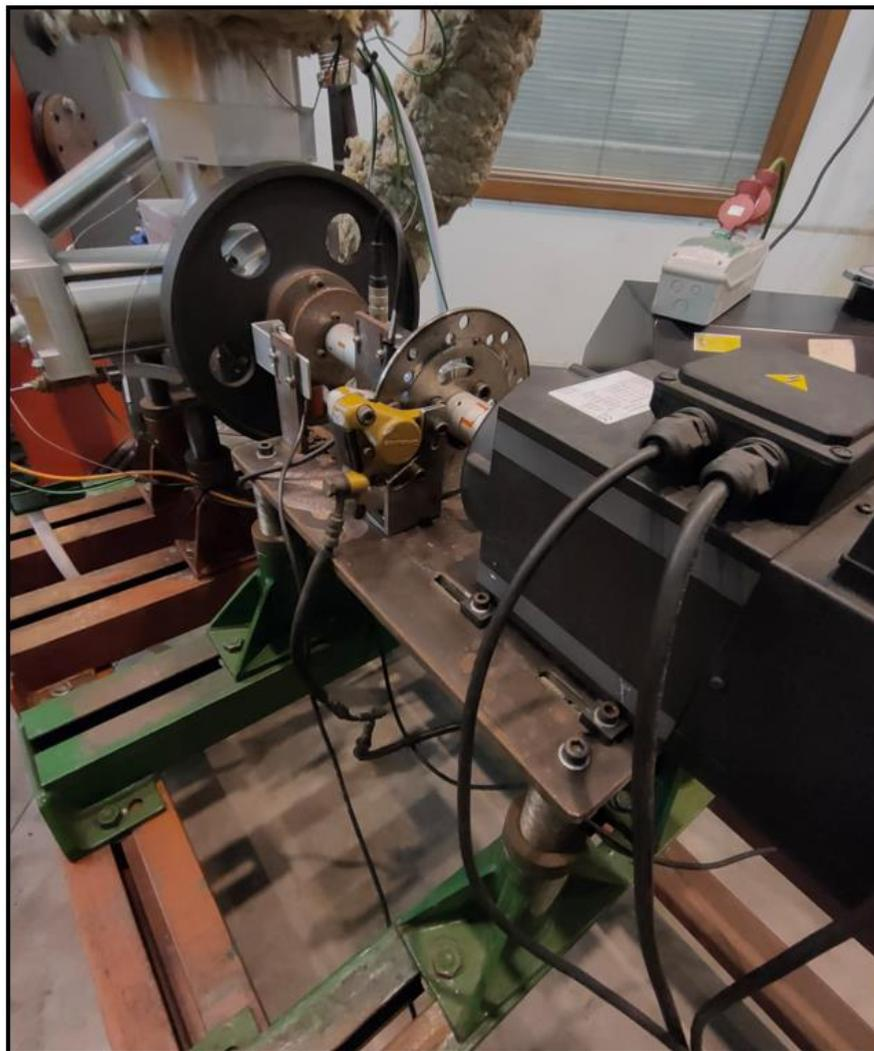
Figura 4.37. Ensamblaje tras incorporación del encóder.
