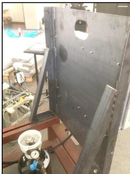
Figura 4.21. Chapa soporte de la aparamenta eléctrica del banco de ensayos.
