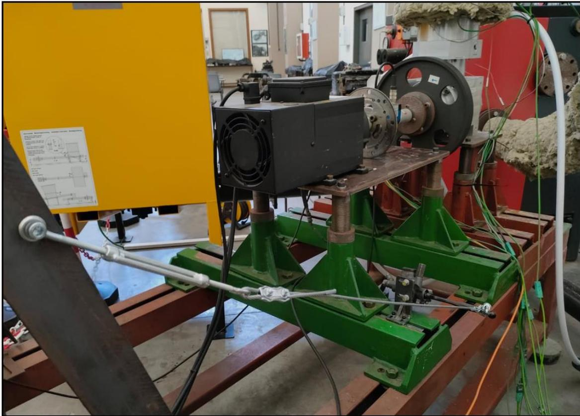
Figura 4.36. Ensamblaje del sistema de accionamiento del freno.
