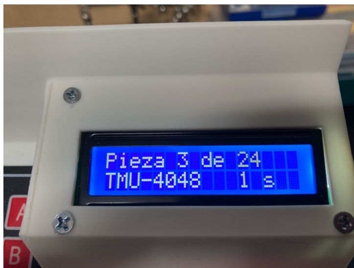
Figura 98. Muestra de la referencia a mecanizar, la pieza y la cuenta atrás
