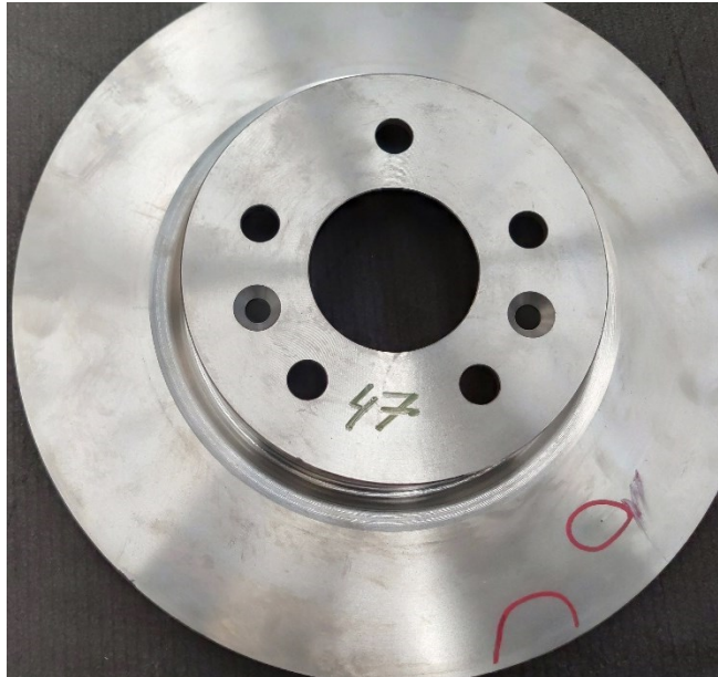
Figura 52. Los discos tienen siete agujeros de sujeción avellanados.
