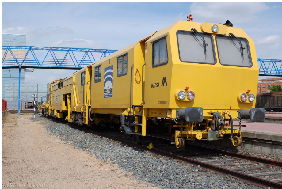
Figura 2.4: Máquina bateadora compactando el balasto debajo en las traviesas de la vía férrea
