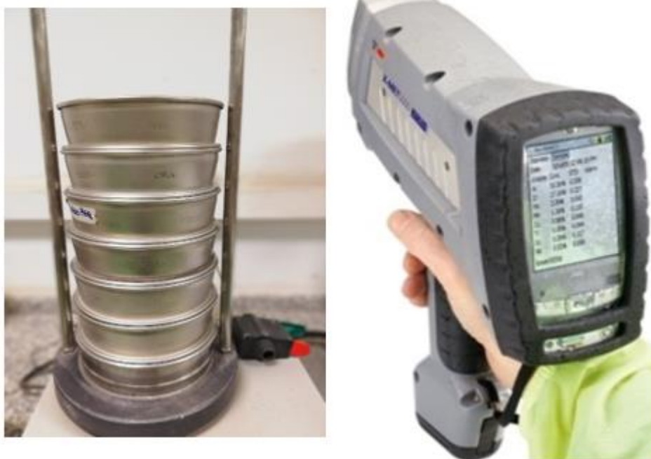
Fig. 3.18- Izquierda: etapa de caracterización químico-mineralógico, usando la técnica de tamizado. Derecha: FRX portátil para análisis de elementos de interés.
