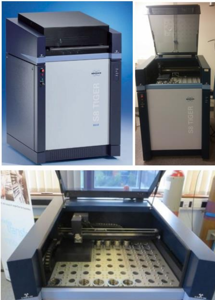
Fig. 3.19 - Ejemplar de equipo de FRX utilizado en la Mina de Penouta.
