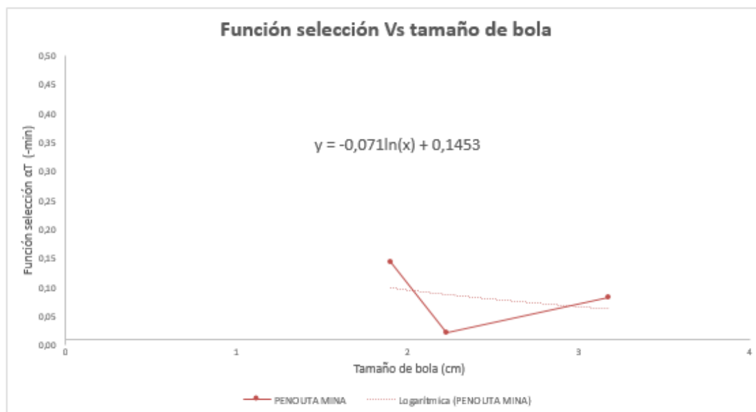
Fig. 4.73 - Función selección vs tamaño de bola a 85% de la velocidad crítica.
