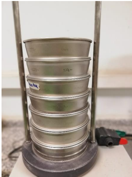
Fig. 3.17 - Tamizadora vibratoria y columna de tamices. Fuente: foto propia tomada en el laboratorio mineralurgia, Universidad de Oviedo-Mieres.
