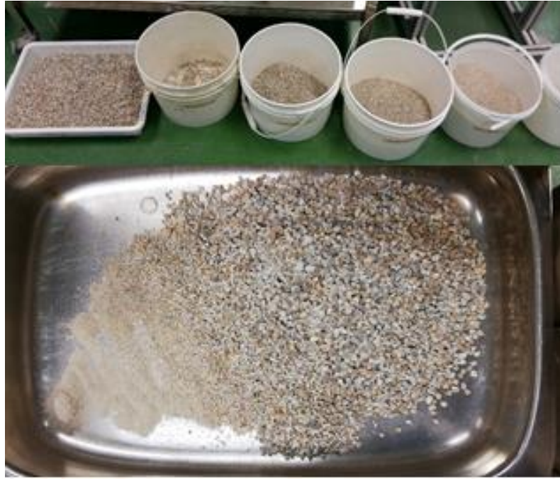
Fig. 3.23 - Monotamaños generados mediante tamizado a partir de la muestra todouno.
