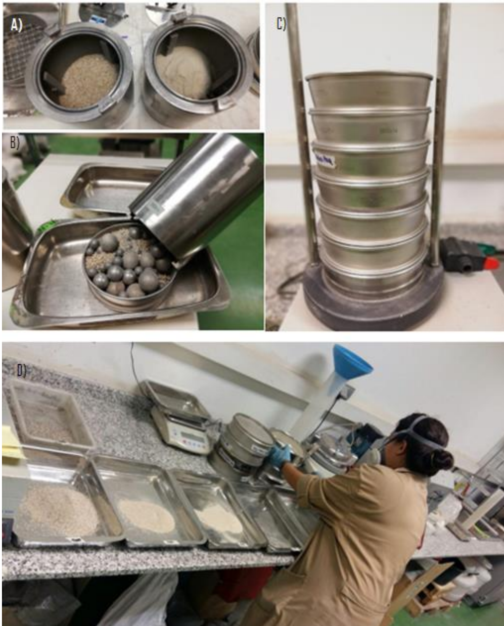
Fig. 3.24 - (A) Alimentación al molino de bolas a escala laboratorio de dos monotamaños diferentes 2000/1000 y 75/45. (B) Tras cada tiempo de molienda, se descarga la carga del molino, tanto de mineral como de bolas. Se usa un tamiz de luz de malla 6mm con la finalidad de retener las bolas y reducir las pérdidas de mineral. (C) Al producto molido, se lleva a tamizar para realizar análisis granulométrico del producto. (D) Producto molido, pasado por tamizado y pesado de retenidos como parte de la caracterización mineralógica.
