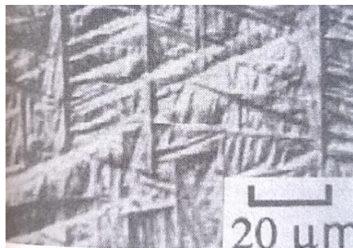
Figura 27. Distorsión que genera la transformación bainítica en la austenita.
